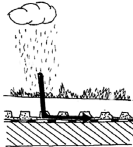
Figura 116. Cubierta vegetal con retención de agua.
