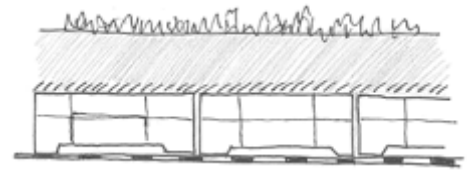
Figura 149. Cubierta extensiva plana gran aljibe.
